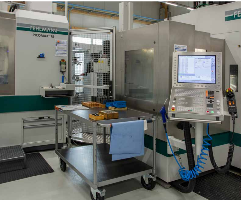
Standardkonstellation: Zwei Maschinen mit einem Palettensystem ermöglichen mannlose Schichten über Nacht und am Wochenende.
